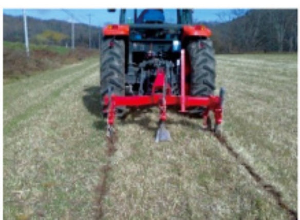
写真3 サブソイラによる心土破碎の実施
